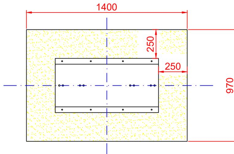
ESQUEMA DE CIMENTACIÓN EN HORMIGÓN
