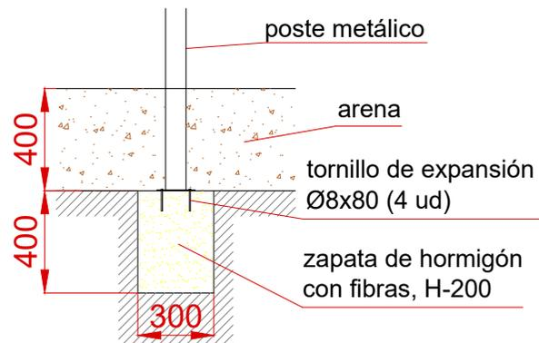
ESQUEMA DE CIMENTACIÓN EN HORMIGÓN
