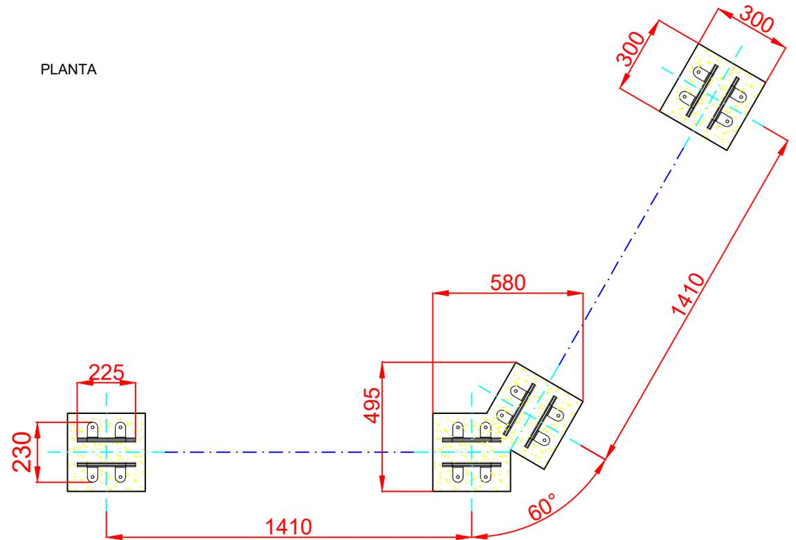
ESQUEMA DE CIMENTACIÓN EN HORMIGÓN
