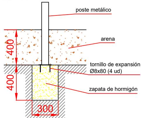
ESQUEMA DE CIMENTACIÓN EN HORMIGÓN
