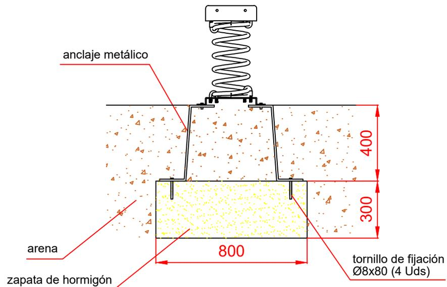
ESQUEMA DE CIMENTACIÓN EN HORMIGÓN
