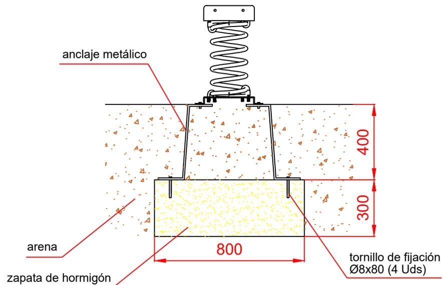
ESQUEMA DE CIMENTACIÓN EN HORMIGÓN
