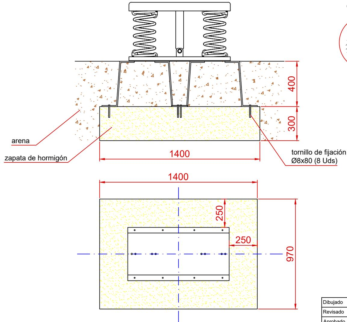
ESQUEMA DE CIMENTACIÓN EN HORMIGÓN
