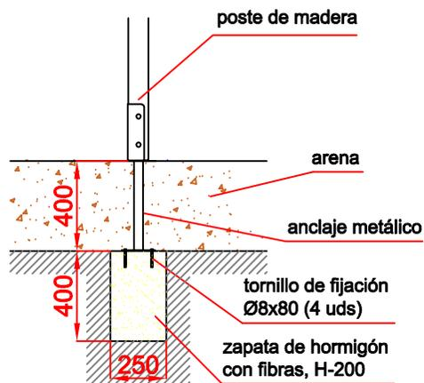
ESQUEMA DE CIMENTACIÓN EN HORMIGÓN
