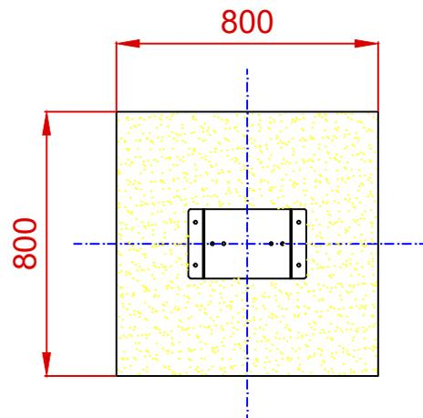
ESQUEMA DE CIMENTACIÓN EN HORMIGÓN
