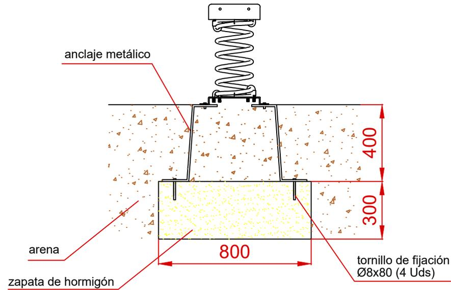
ESQUEMA DE CIMENTACIÓN EN HORMIGÓN
