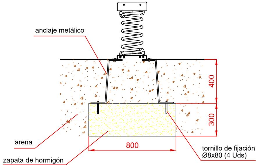
ESQUEMA DE CIMENTACIÓN EN HORMIGÓN
