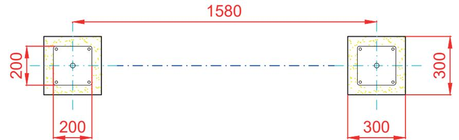
ESQUEMA DE CIMENTACIÓN EN HORMIGÓN
