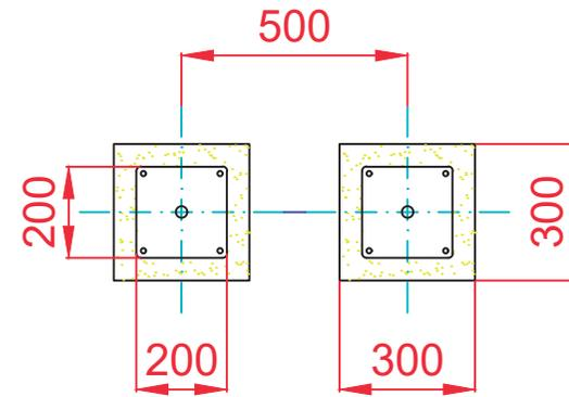
ESQUEMA DE CIMENTACIÓN EN HORMIGÓN
