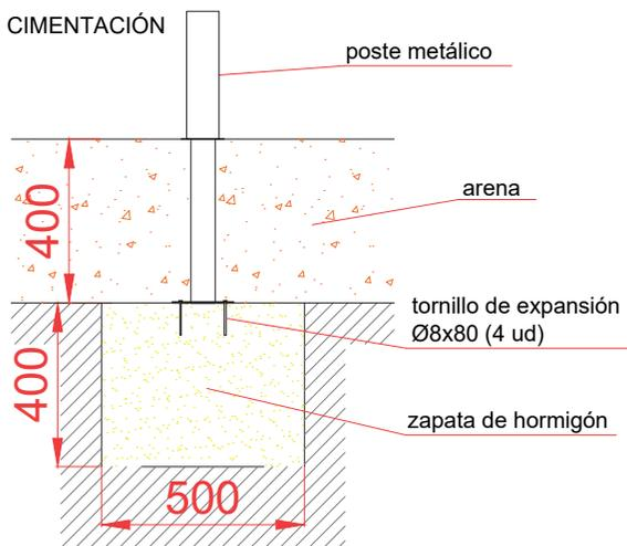
ESQUEMA DE CIMENTACIÓN EN HORMIGÓN
