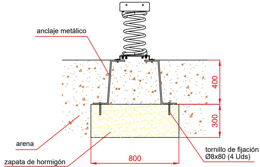
ESQUEMA DE CIMENTACIÓN EN HORMIGÓN
