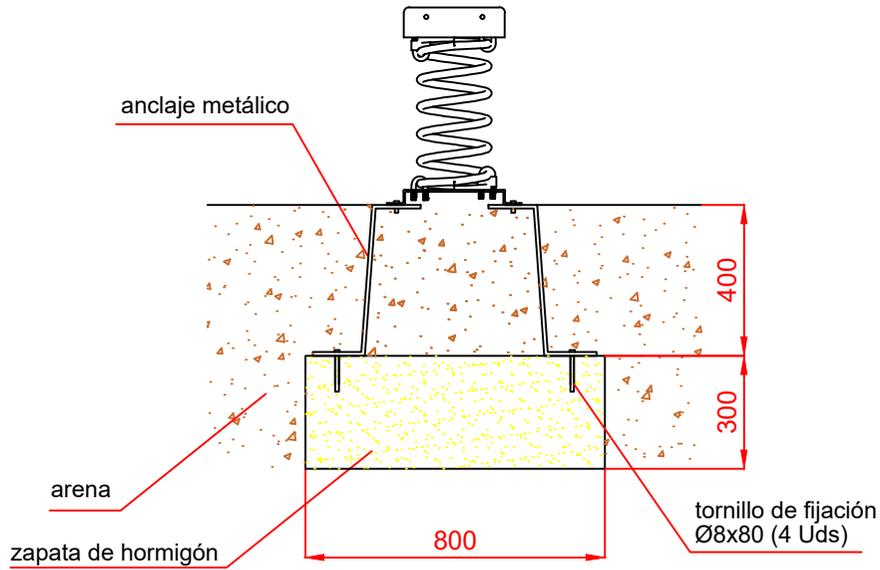
ESQUEMA DE CIMENTACIÓN EN HORMIGÓN
