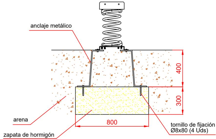
ESQUEMA DE CIMENTACIÓN EN HORMIGÓN
