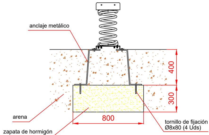
ESQUEMA DE CIMENTACIÓN EN HORMIGÓN
