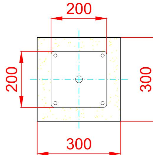
ESQUEMA DE CIMENTACIÓN EN HORMIGÓN
