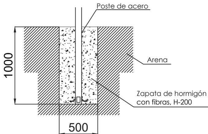
ESQUEMA DE CIMENTACIÓN PLACAS EN HORMIGÓN
