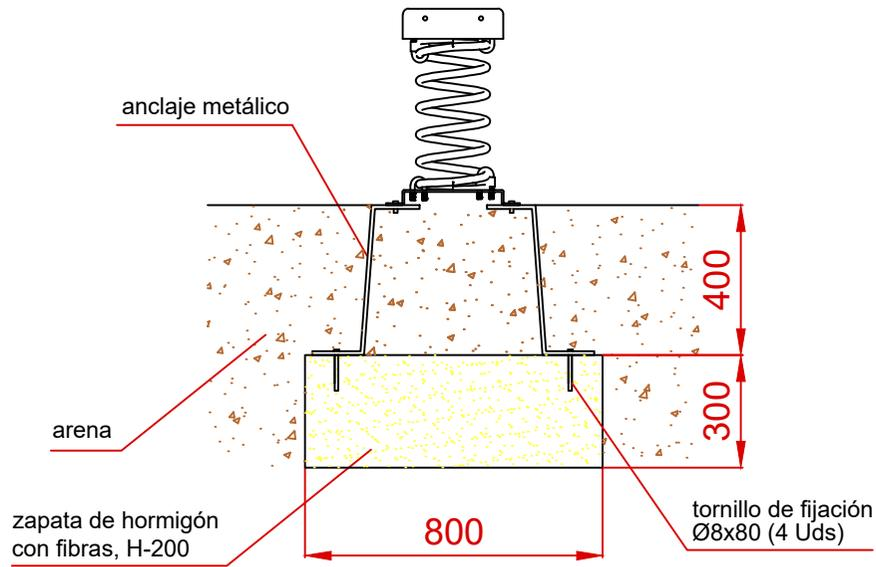
ESQUEMA DE CIMENTACIÓN EN HORMIGÓN
