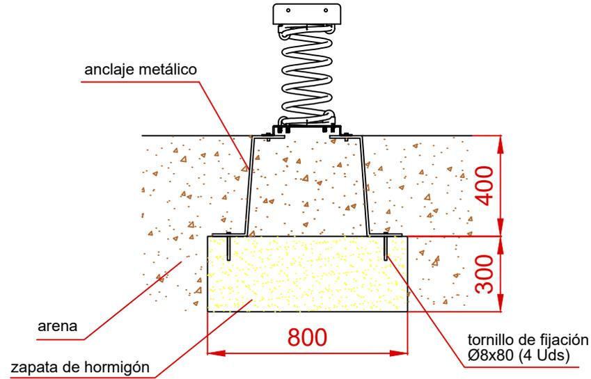
ESQUEMA DE CIMENTACIÓN EN HORMIGÓN
