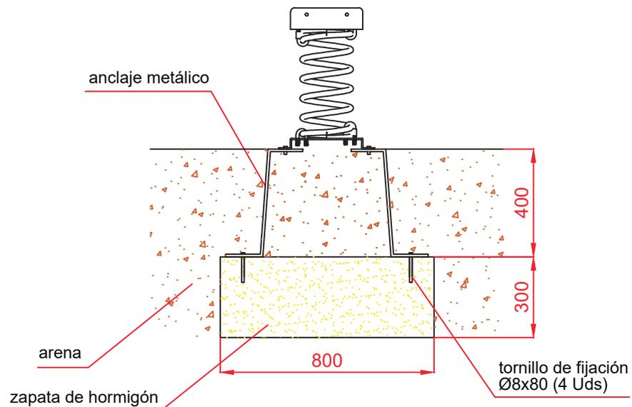
ESQUEMA DE CIMENTACIÓN EN HORMIGÓN
