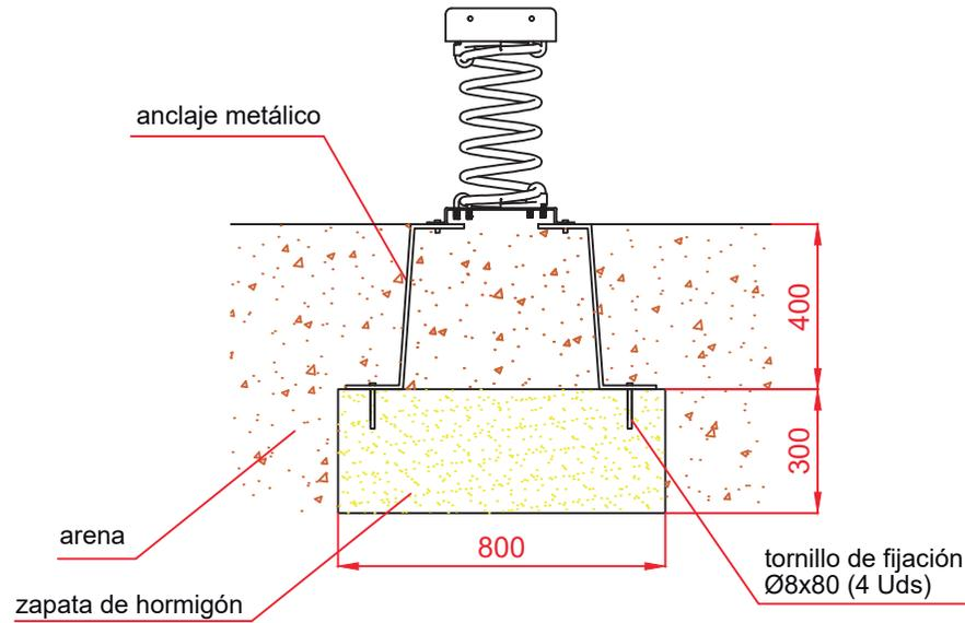
ESQUEMA DE CIMENTACIÓN EN HORMIGÓN
