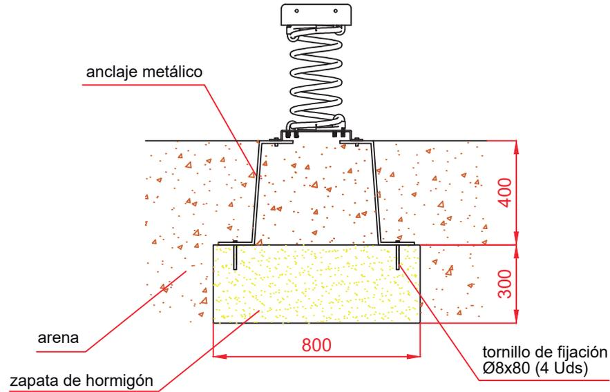
ESQUEMA DE CIMENTACIÓN EN HORMIGÓN
